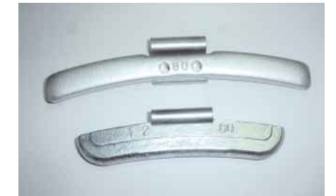
鉛フリー・バランスウエイト (上:17.5インチ用/鉄、下:15.16インチ用/亜鉛)
