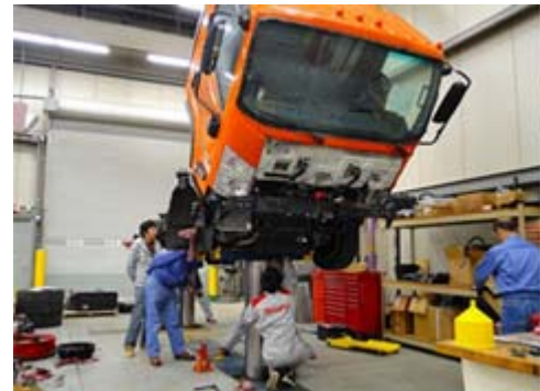
被水した車両の分解調査
