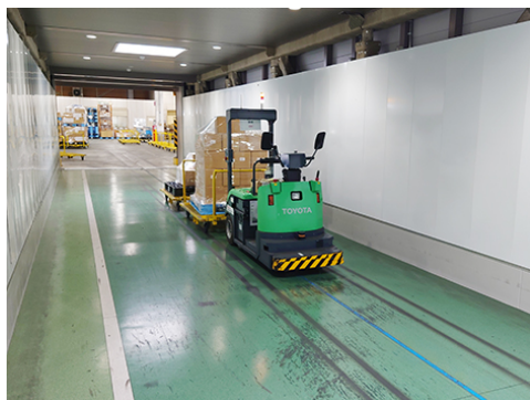
倉庫間の輸送を無人けん引車で実施
