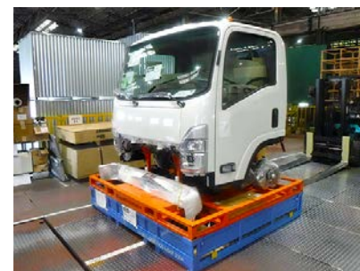
キャブ用リターナブルラック（オレンジ）+ 部品用リターナブルラック（ブルー）
